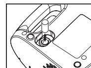
Aby wymienić filtr, wyciągnij go w sposób pokazany na rysunku.
