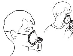
**ACHTUNG:** Wenn sich nach der Therapiesitzung eine offensichtliche Feuchtigkeitsablagerung im Inneren des Schlauchs (B1) bildet, nehmen Sie den Schlauch vom Vernebler ab und trocknen Sie ihn mit der Belüftung des Kompressors. Diese Maßnahme verhindert eine mögliche Schimmelbildung im Inneren des Schlauchs.
